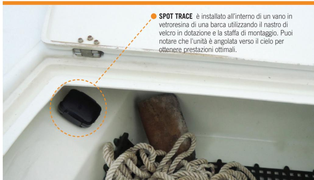
● **SPOT TRACE** è installato all'interno di un vano in vetroresina di una barca utilizzando il nastro di velcro in dotazione e la staffa di montaggio. Puoi notare che l'unità è angolata verso il cielo per ottenere prestazioni ottimali.
