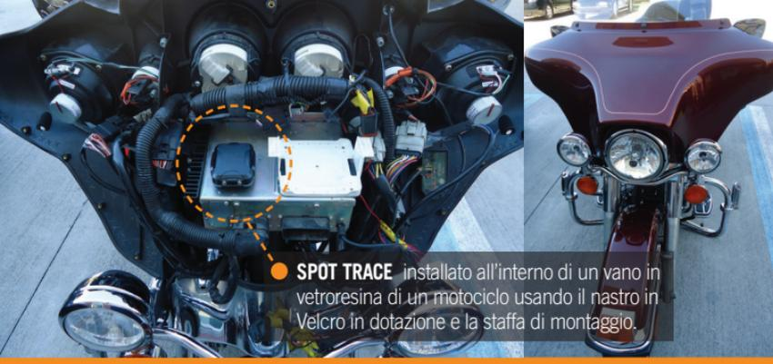
● **SPOT TRACE** installato all'interno di un vano in vetroresina di un motociclo usando il nastro in Velcro in dotazione e la staffa di montaggio.
